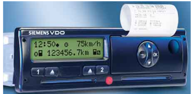
Einbaupflicht für Neufahrzeuge ab Mai 2006 - der digitale Tachograph (Quelle: Siemens-vdo)
